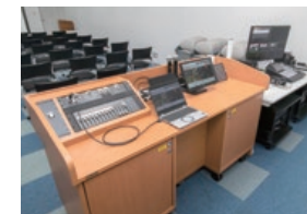
▲ 講義室後方のAV操作卓。左端がデジタルミキサーのフェーダーユニットWR-PU200
