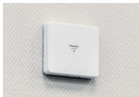
▲ ワイヤレスアンテナWX-SA250Aは2台設置
