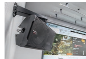
▲ RAMSA30cm2ウェイスピーカーWS-AR200-Kは左右に配置
