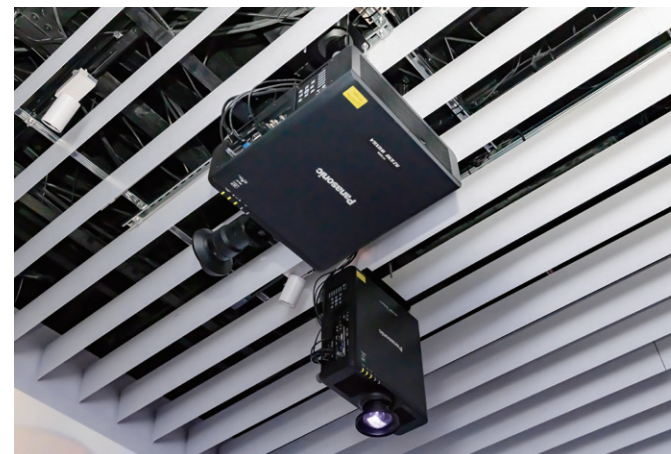
▲ 「ヴィランズ・ルーム」の1チップDLP®レーザープロジェクターPT-RZ690JLB。真下に向けたプロジェクターは床面への投写用。壁面への投写用は短い距離で投写可能な超短焦点ズームレンズを使用
